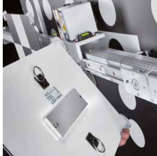
Terče jednoduše nastříct pomocí magnetického držáku na přesné lože
