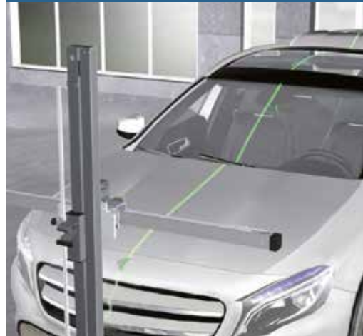
Vyrovnaní k vozidlu pomocí čárového laseru
